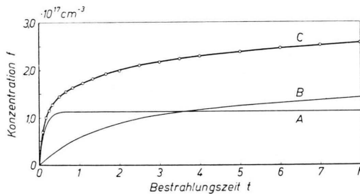
Abb. 1. Zeitlicher Verlauf der F-Zentrenbildung für NaCl. Kristalldicke \sim 0,12 mm, Meßwerte als Kreise dargestellt. Kurve C berechnet nach Gl. (3), Kurve A nach Gl. (1 a), Kurve B nach Gl. (2 a) mit den Werten a=5,68 \cdot 10^{15} \text{ cm}^{-3} \text{ h}^{-1} , b=8,29 \text{ h}^{-1} , c=0,723 \text{ h}^{-1} , n_0=1,12 \cdot 10^{17} \text{ cm}^{-3} , n_1=1,07 \cdot 10^{17} \text{ cm}^{-3} .
